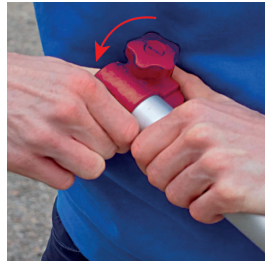
3. Vrid tills låset snäpper fast
